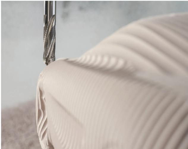
2 Blockmaterial im Eilgang zu bearbeiten ist von den Maschinenherstellern nicht vorgesehen; mit dem 'Blockbuster' von Hufschmied ist es aber möglich
